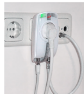
15. ábra: TV, videó, multimédia túlfeszültség-védelme családi házak esetén
