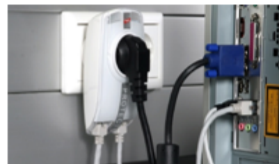
16. ábra: Számítógép túlfeszültség-védelme
