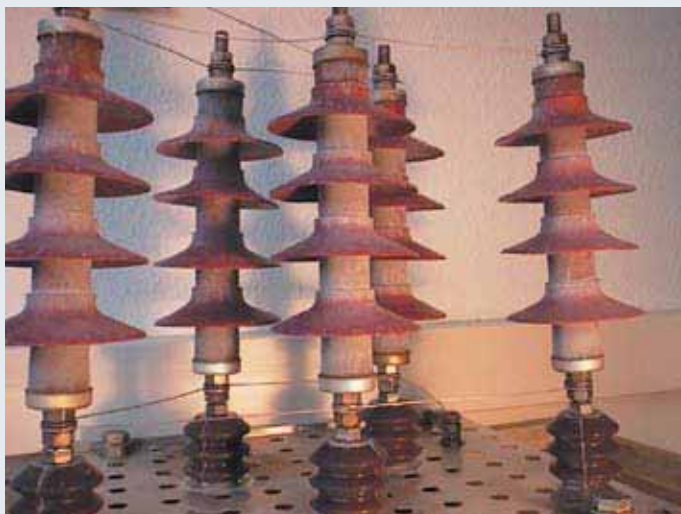
Bild 1: DEHNmid-Ableiter mit schweren Salzablagerungen nach einem 5000 Stunden-Test mit zyklisch wechselnder Belastung bestehend aus Regen, Salzwasser-Sprühnebel, Temperaturschwankungen und UV-Bestrahlung bei gleichzeitigem Anliegen der Dauerspannung U_C .
