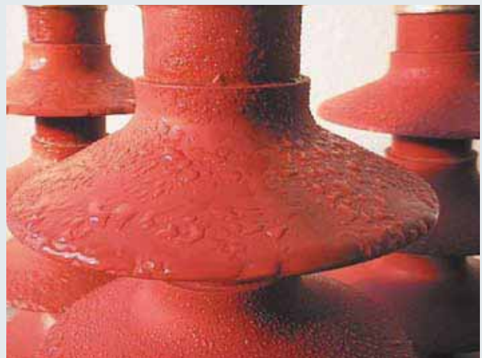
Bild 2: Regeneration der wasserabweisenden Eigenschaften der im 5000 Stunden-Test schwer belasteten Ableiter bereits nach wenigen Stunden.
