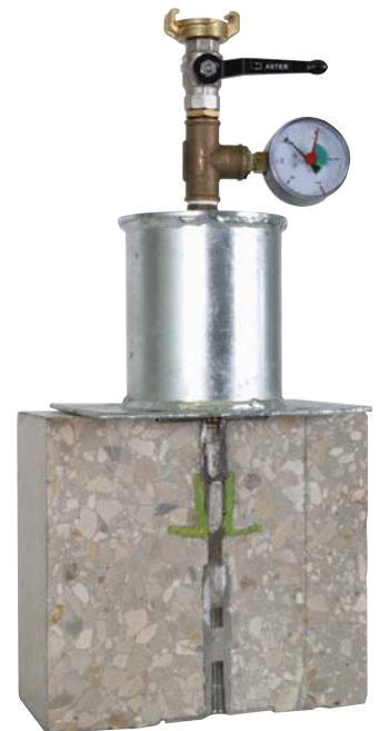
Prüfaufbau (Schnittbild) mit Anschluss für die Druckwasserprüfung
