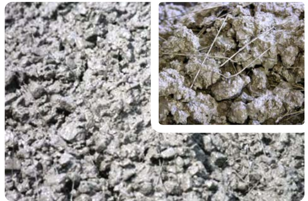
Frischbeton mit Stahlfasern Weitere Informationen unter www.vdsev.de
