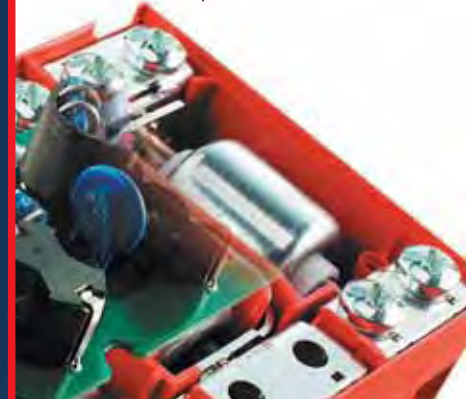
a DEHNventil® TT N-PE szikraköz belső felépítése
