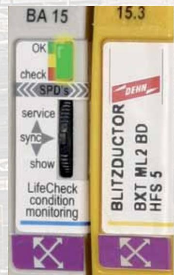
Überwachungsgerät DRC MCM XT mit optischer Zustandsanzeige neben dem Schutzgerät BLITZDUCTOR® XT mit LifeCheck®
