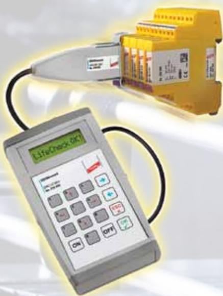
Überwachungsgerät DRC MCM XT mit optischer Zustandsanzeige neben einem Ableiter mit LifeCheck®
