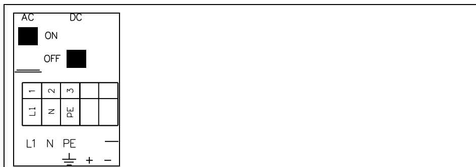
6-5. ábra Csúszó kapcsolók helyzete a kapocstérben
