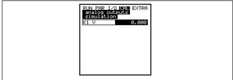
8-86. ábra A kimeneti érték megadása
