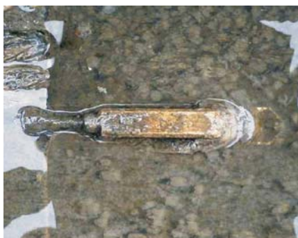
Az ék szenzor teljesen megbízhatóan működik az erős szennyeződés ellenére is.
