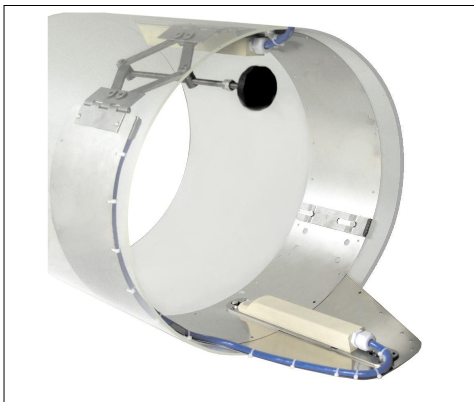
6-7 ábra RMS2 rögzítő rendszer kiegészítő lemezzel ék- és levegő ultrahangos érzékelő együttes használatához
