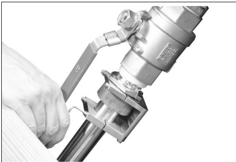
4-35 ábra Az utolsó szorítókeggyel felhelyezése
