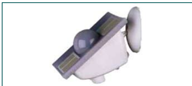
3. ábra Komplex meteo jeladó/érzékelő fej – DCF77 rádió szinkron jel vétele és továbbítása a KNX busz felé – eső, szél, hőmérséklet, pillanatnyi megvilágítás függő kapcsolási parancs, megvilágítási jellemzők, világítási határértékek mérése, mérési eredmények kijelzése, hibaüzenetek kijelzése
