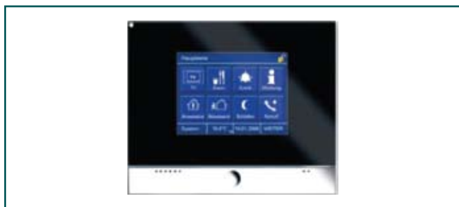
5. ábra Komplex Érintőképernyős parancsadó, vezérlőtábla – INFRA távvezérlő jel vétele és továbbítása a KNX busz felé – helyi kapcsolási parancsok kiadása esemény függő kapcsolási parancsok kiadása, szabályozási jellemzők, paraméterek továbbítása a KNX Busz felé – mérési eredmények kijelzése, hibaüzenetek kijelzése
